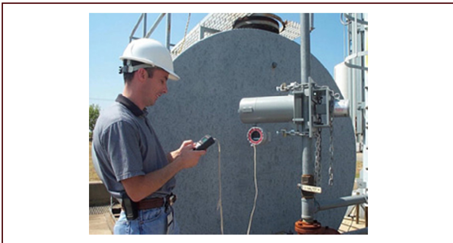
شکل ۲۲- اندازه گیری چگالی در خروجی چاه نفت
