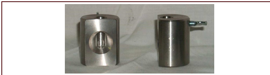
شکل ۷۹- کالیما تور یا محدود کننده پرتو
