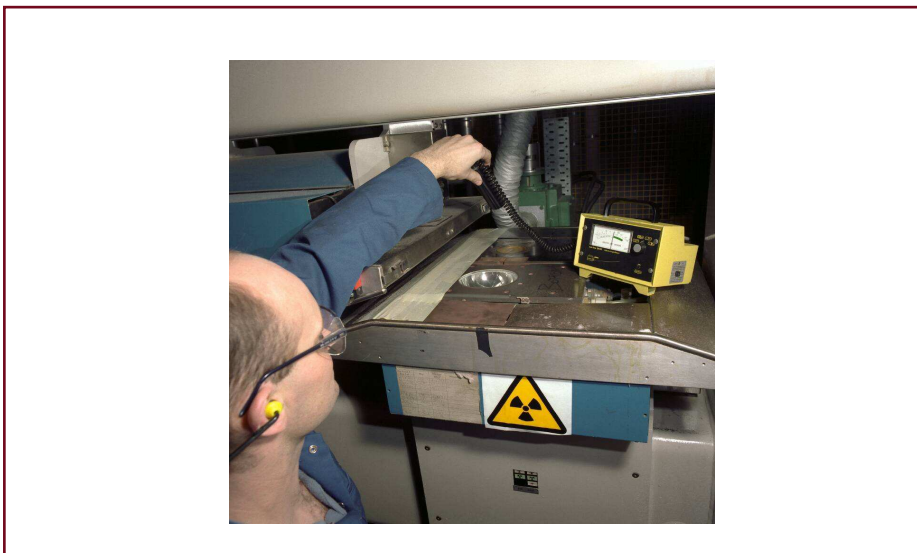
شکل ۶۰- مونیتورینگ پرتو هنگام تعمیر سنجشگر پرتوی
