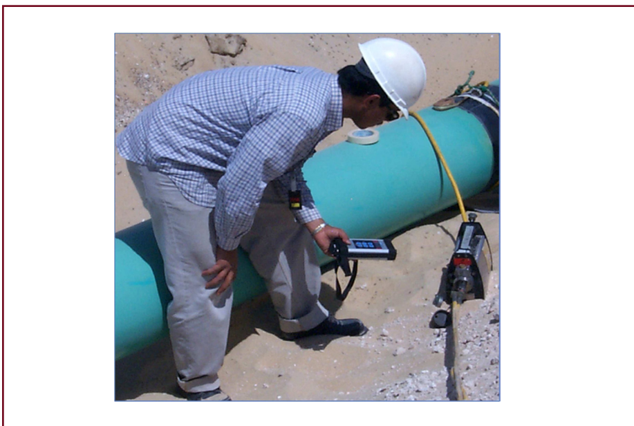
شکل ۶۱- مونیتورینگ پرتو پس از پایان پرتودهی به منظور اطمینان از بازگشت چشمه
