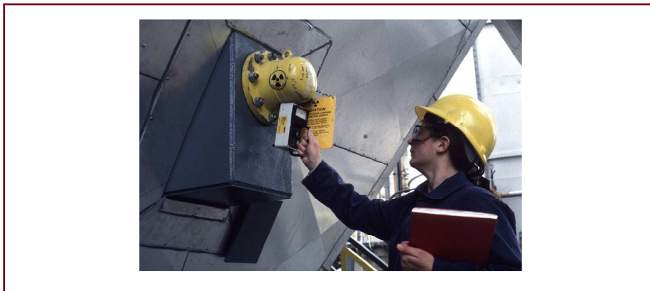
شکل ۶۴- مونیتورینگ پرتو نشتی در سطح کانتینر سطح سنج پرتوی
