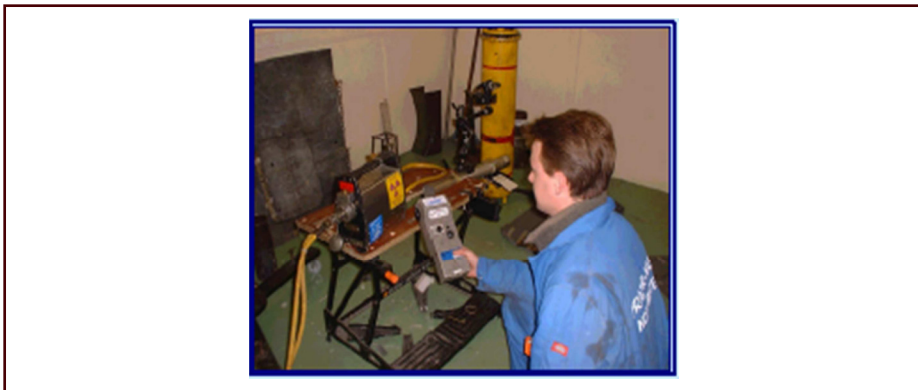
شکل ۸۳- نمونه ای از روش انجام مونیتریگ محیطی در عملیات پرتونگاری صنعتی
