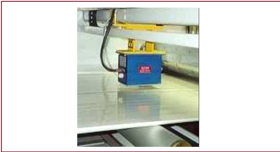
شکل ۱۶- کاربرد روش پس پراکنی در ضخامت سنجی
