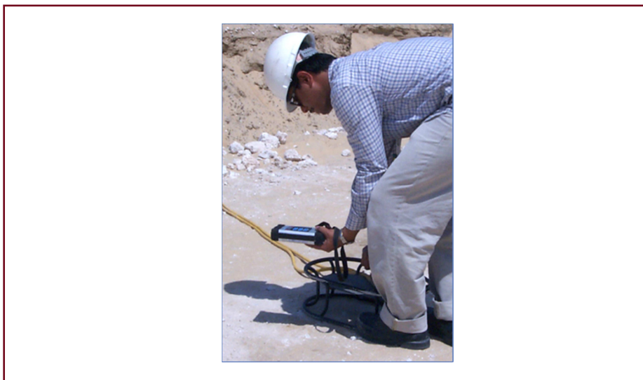
شکل ۶۵- اندازه گیری آهنگ دز در محل کار اعضای تیم پرتونگاری
