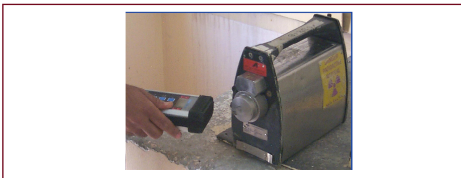
شکل ۶۲- مونیتورینگ پرتو نشستی در سطح دوربین پرتونگاری صنعتی
