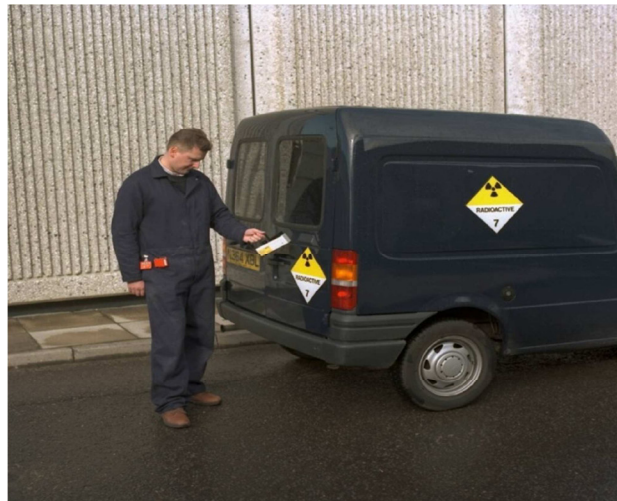
شکل ۵۹- مونیورینگ پرتو در سطح وسیله نقلیه
