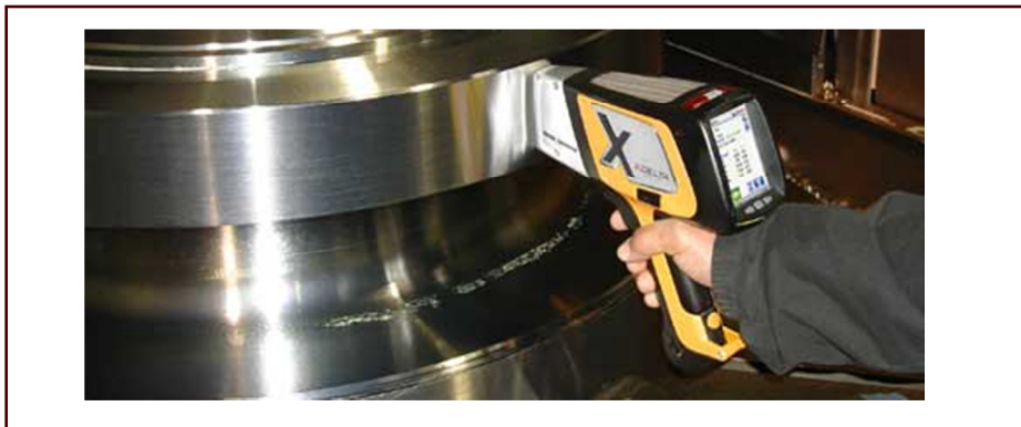
شکل ۲۸- دستگاه آنالایزر قابل حمل XRF
