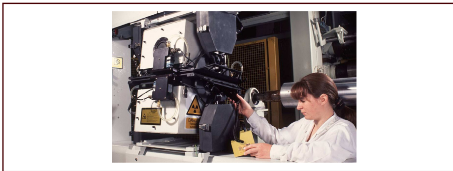
شکل ۶۶- حداکثر آهنگ دز نباید در فاصله ۵ سانتیمتر از سطح خارجی کانتینر بیشتر از 500 \mu\text{Sv/h} باشد.
